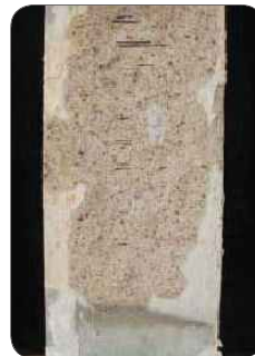
<그림 2> 내화보드 건식 공법(건식피복없음)
