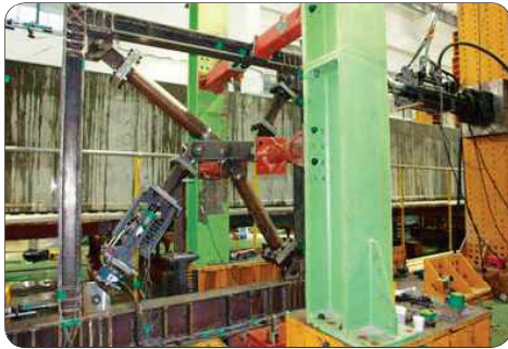
〈그림 2〉 다중변위증폭 제진시스템
