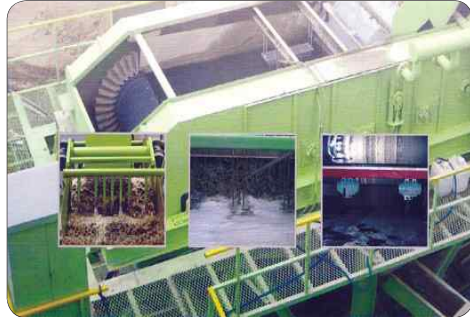
〈그림 1〉 초음파 발전기와 골재 진동판이 적용된 수조의 모습
